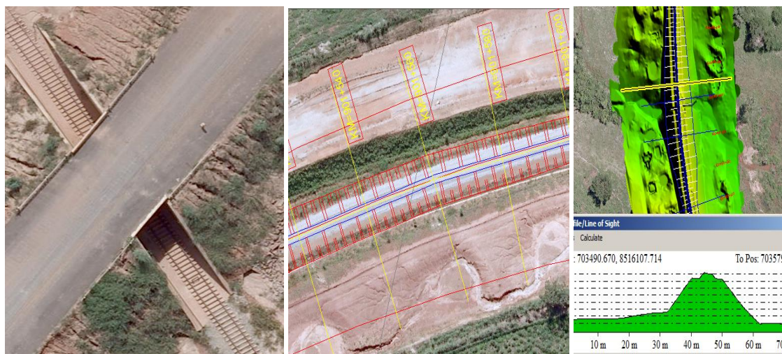
Figura 4 – Foto aérea, sobreposição seção projeto e MDT/Seção transversal
